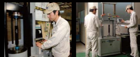
「左:圧縮荷重試験」 「右:減衰力試験」
